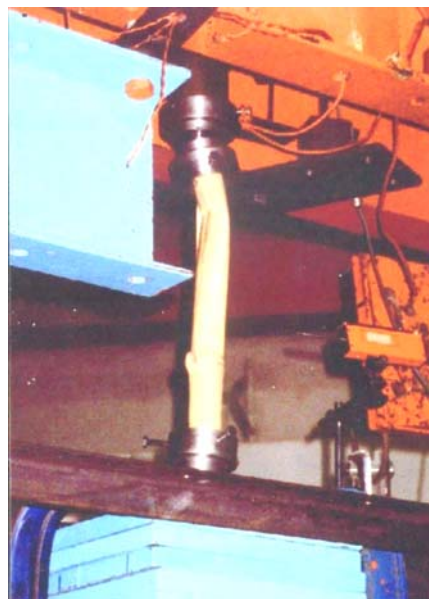
b) Local buckling
