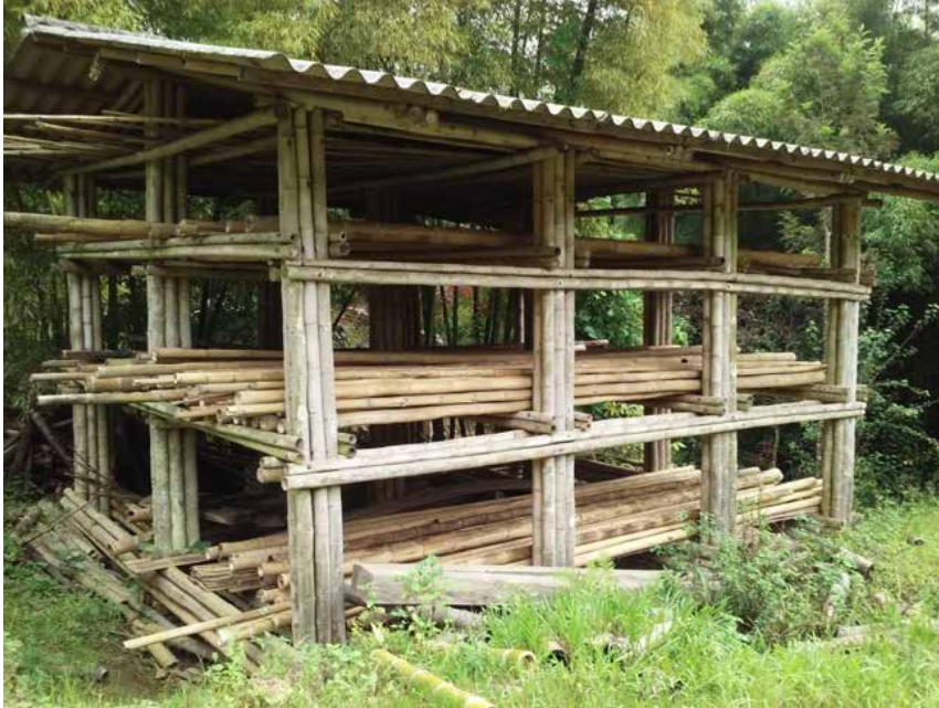
Figura N° 17. Secado horizontal bajo cubierta
