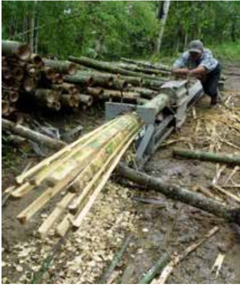
Figura N° 25. Obtención de latillas con máquina operada manualmente
