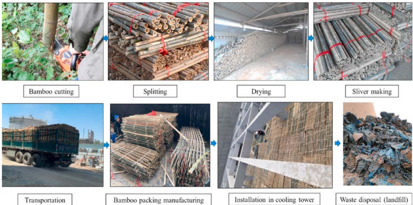
Analyse du cycle de vie du packing en grilles de bambou dans une tour de refroidissement. Crédit : Ma Xinxin et al.
