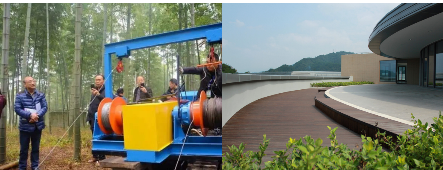
从左至右:竹木缆索式拖拽机。竹工程复合材料用于耐用型户外设施(供图:浙江大庄实业集团)。
