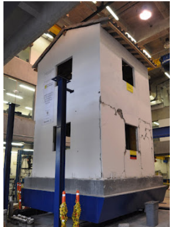
Gauche : Des lattes de bambou fendues clouées sur des cadres en bambou à « Bambusa » en Colombie : c'est le premier projet de logements à être conçu conformément au chapitre E.7. Architecte : Jaime Mogollón ; Ingénieur : Samuel D. Prieto. Droite : Une maison bahareque d'ingénierie sur un simulateur sismique à l'université de Los Andes. Ses performances sismiques sont excellentes. Crédit : David Trujillo.
