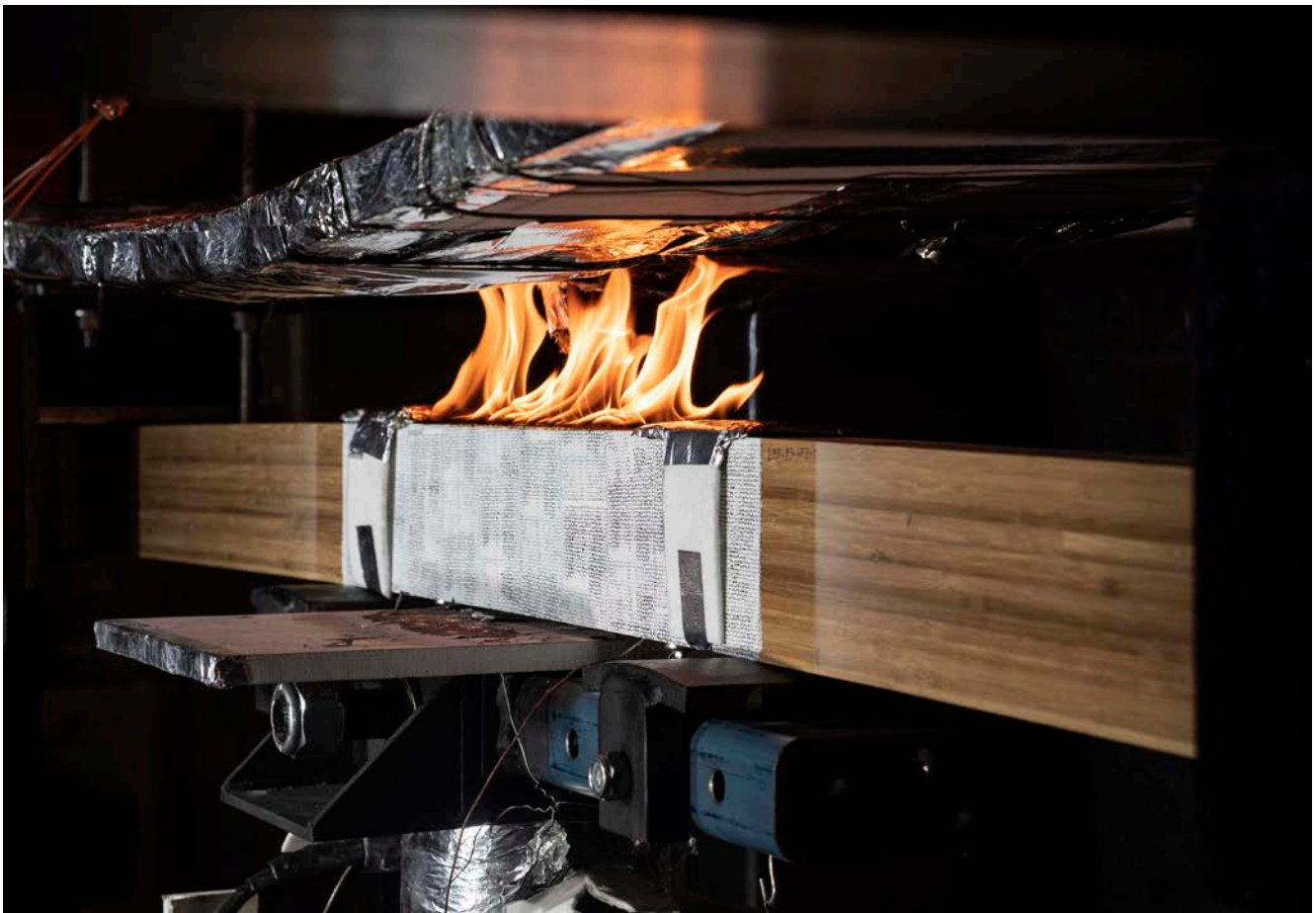
Au cours d'une expérimentation, des poutres de bambou stratifiées sont chargées de poids et brûlées simultanément. Crédit : Geneviève Worrell
