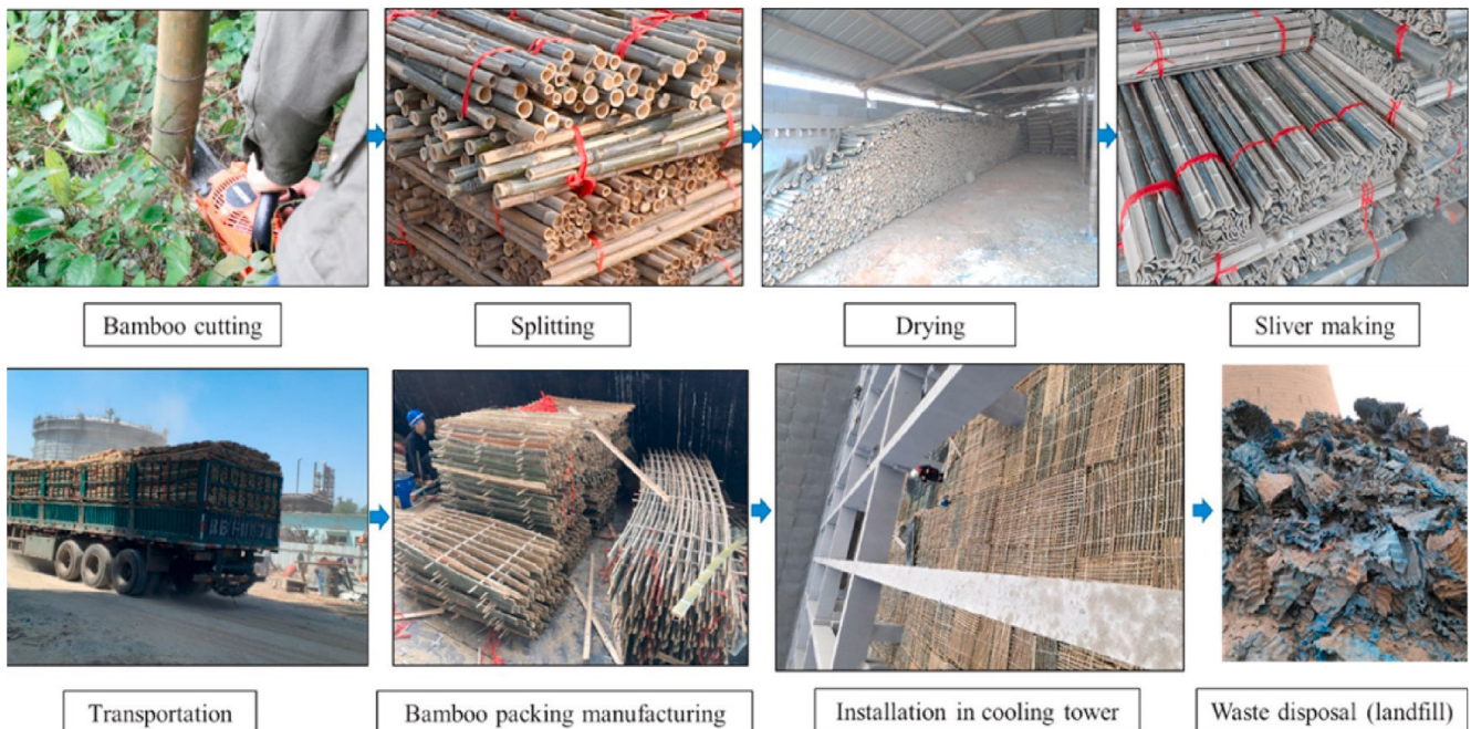
Pasos del análisis del ciclo de vida del empaque de rejilla de bambú en una torre de enfriamiento. Crédito: Ma Xinxin et al.
