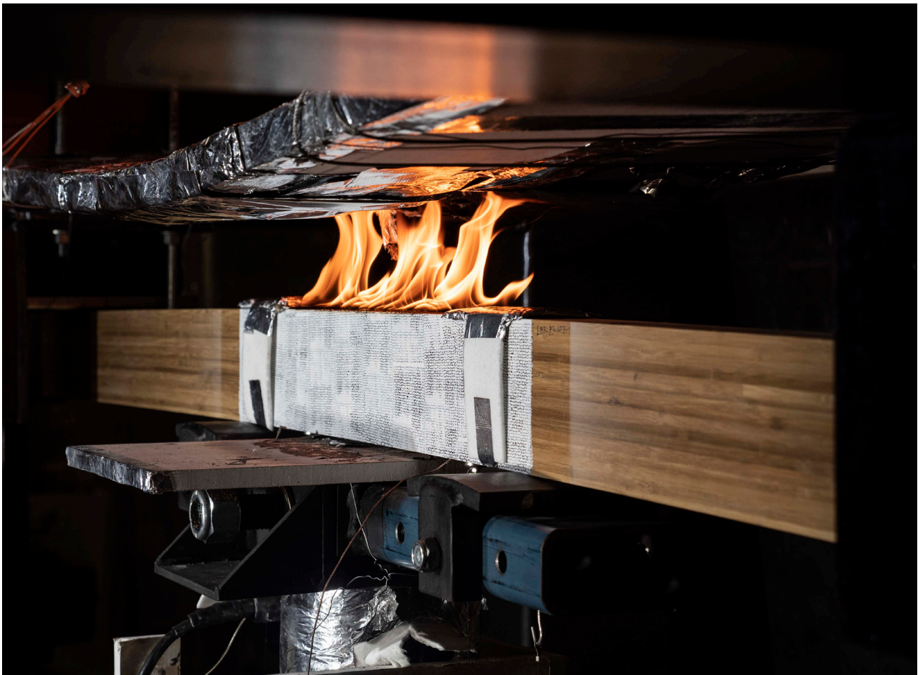
Durante un experimento de fuego, las vigas de bambú laminadas son expuestas a cargas y a fuego simultáneamente. Crédito: Genevieve Worrell.
