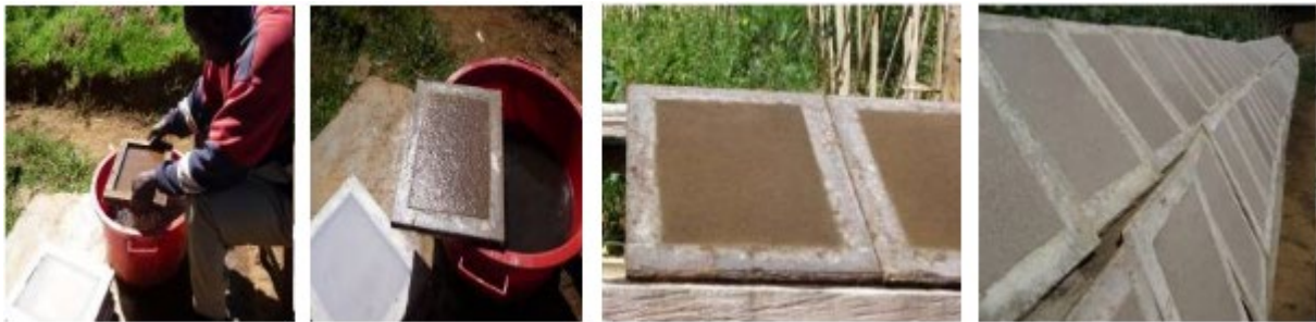
Figure 44: Processus de fabrication de papier à base de bambou, Oku, Nord-Ouest (Ingram et al., 2010)
