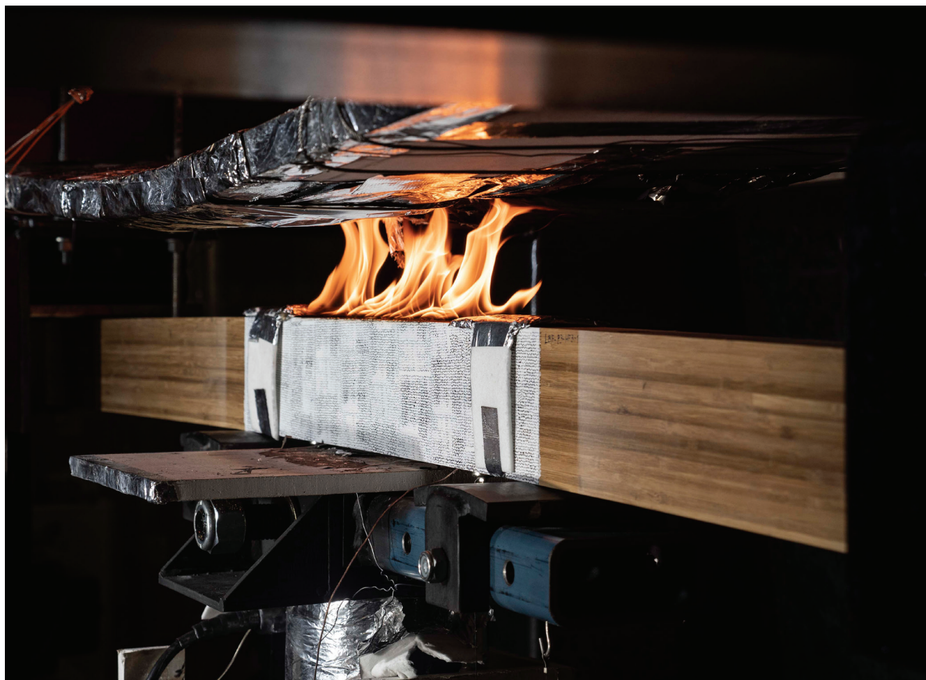
在火灾实验中，竹集成材梁柱在承重状态下燃烧。供图：Genevieve Worrell
