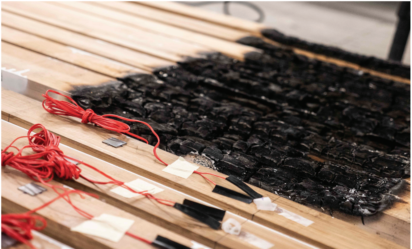
这些实验结果可帮助设计师和工程师建造具有更佳耐火性能的竹建筑。供图：Genevieve Worrell
