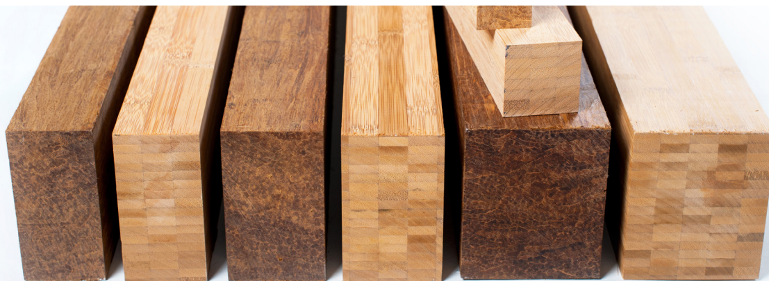
Vigas de bambú de ingeniería fabricadas con bambú laminado (color amarillo) y bambú densificado (color marrón). Crédito: MOSO International.
