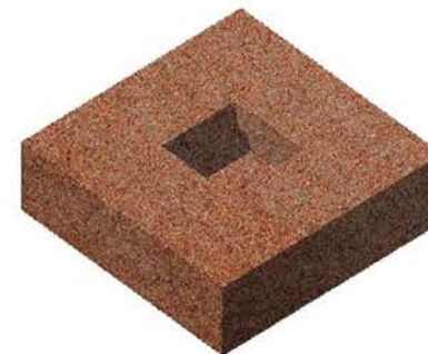
Extracción de suelo compuesto por arcillas expansivas
