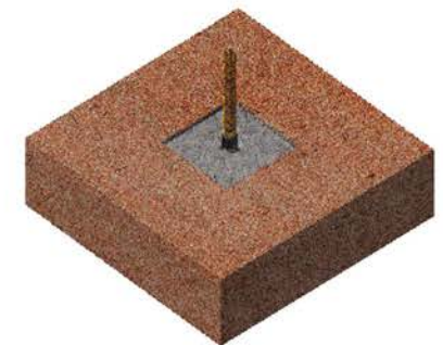
Sustitución de suelo compuesto por arcillas y grava.
