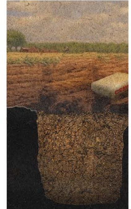
Sustitución de suelo compuesto por arcillas y grava.
