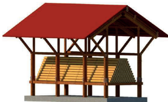
FIGURA 80 CUBIERTA PROVISIONAL EN OBRA
