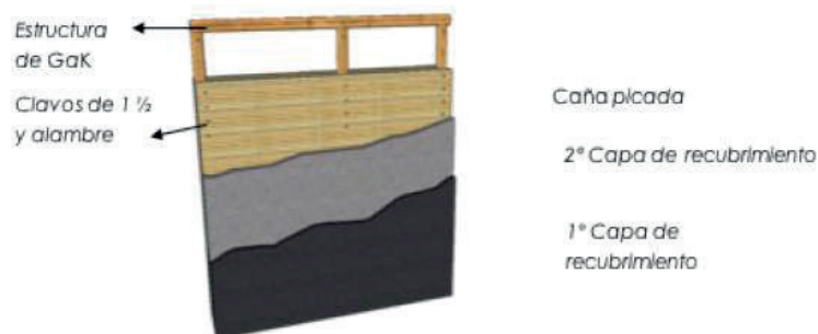
FIGURA 134 RECUBRIMIENTO DE PAREDES CON MORTERO DE ARENA CEMENTO
