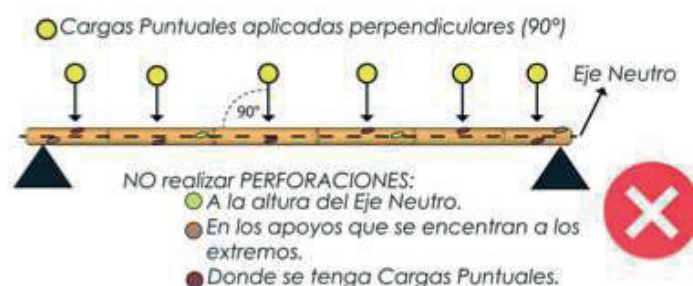
FIGURA 45 PERFORACIÓN EN ZONAS DE TENSIÓN
