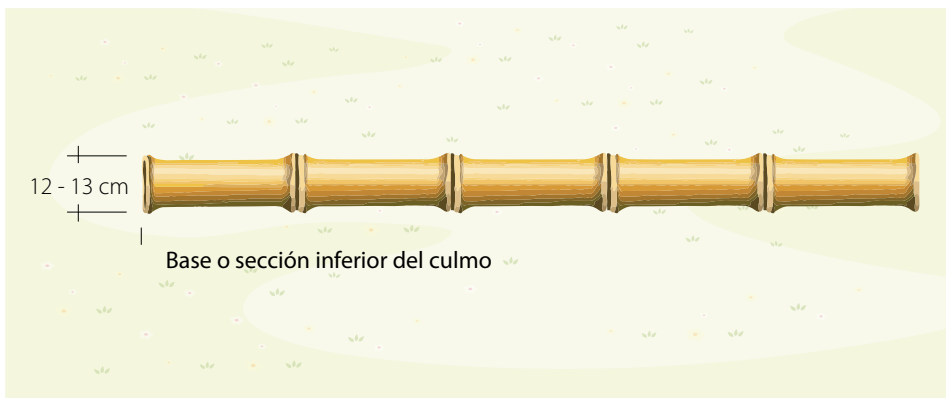
Ilustración 13. Base o sección inferior del culmo para columna.
