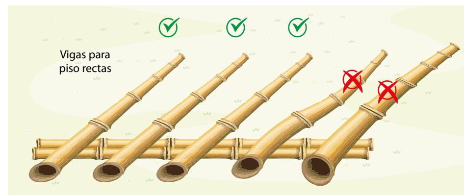
Ilustración 21. Vigas para pisos.
