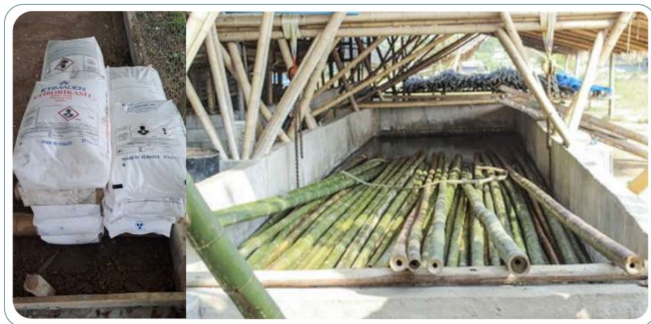
Ilustración 2: Ácido bórico y bórax, piscina de preservado.
