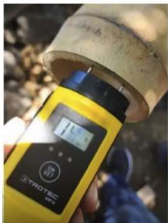
Ilustración 14: Uso del higrómetro digital.
