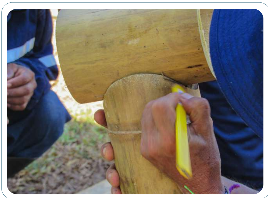
Ilustración 6: La exactitud del corte garantiza duración prolongada.
