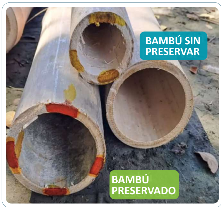
Ilustración 15: Prueba cualitativa de penetración del preservante (prueba de cúrcuma).
