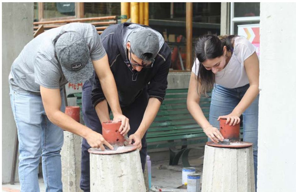
Lijado fino para lograr un acabado superficial uniforme y estético.
